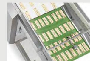
Optional: Mise en plaque électrique avec mouvement de la plaque pour double décharge produits. Vitesse et voyage décharge du produit programmable
